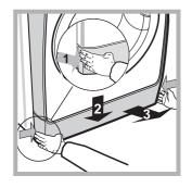
1. remova o painel de cobertura no lado anterior da máquina empurrando para o centro, em seguida empurre para baixo de ambos os lados e remova-o (veja as figuras).
